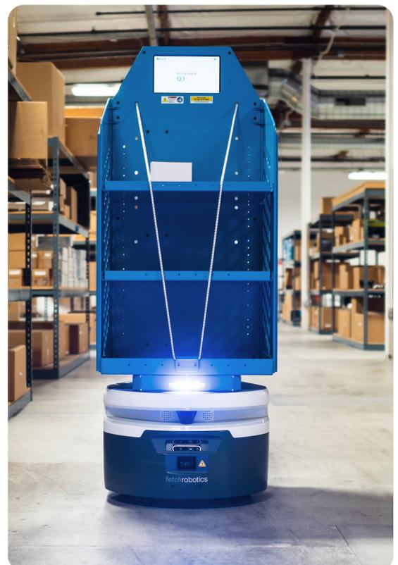
In diesem Stadium ist der Einsatz von Robotern in einer temperaturkontrollierten Umgebung zwar Theorie, aber möglich, da sie in der Lage sind, Temperaturen von bis zu  $-25^{\circ}\text{C}$  auszuhalten. Ihre einzige Einschränkung besteht darin, dass sie nicht immun gegen Kondensation sind – was bedeutet, dass sie sich nur innerhalb einer einzigen Temperaturzone aufhalten können. Wenn Roboter jedoch auf eine Tiefkühl- oder Kühlzone beschränkt sind, sollte dies kein Problem darstellen.
